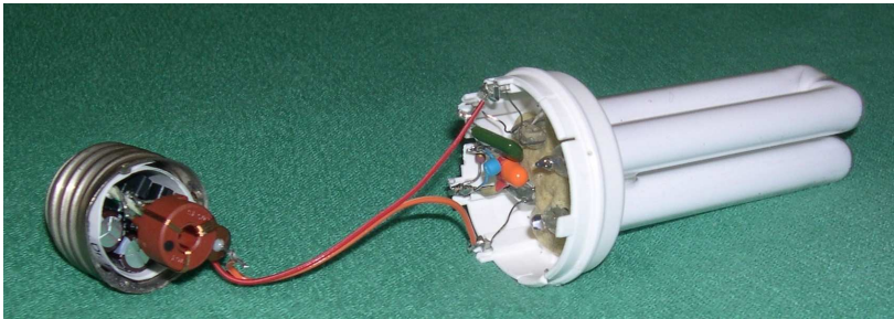
Abb. 9: Erster Prototyp eines neu entwickelten, zum Patent angemeldeten 11 W Vorschaltgerätes
